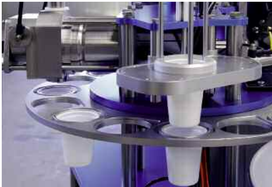
Links der Zylinder aus Chromstahl, der das Joghurt portionenweise in die Becher abfüllt.
