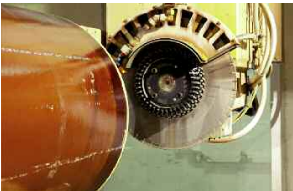
Die Rohrenden werden mittels Kombiwerkzeugen beidseitig abgesägt und gefräst.
