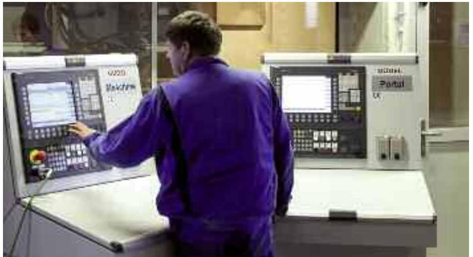
Die beiden Kommandopulte für Portal-Roboter und Bearbeitungsmaschine sind ausserhalb der Einhausung, jedoch mit Sicht auf den Bearbeitungstisch platziert.
