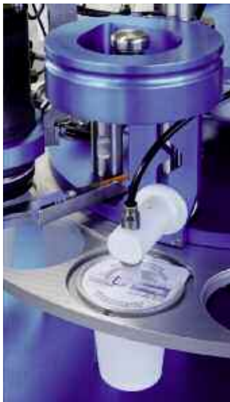
Der Deckel wird positioniert und im nächsten Schritt mit dem temperaturgeregelten Versiegelungskopf aufgeschweisst.
