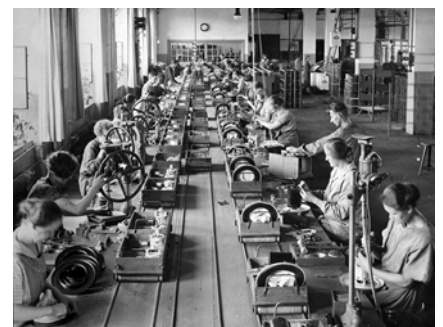
»Fließarbeit in höchster Vollendung«: Die Montagestraße für Staubsauger setzt Maßstäbe.
