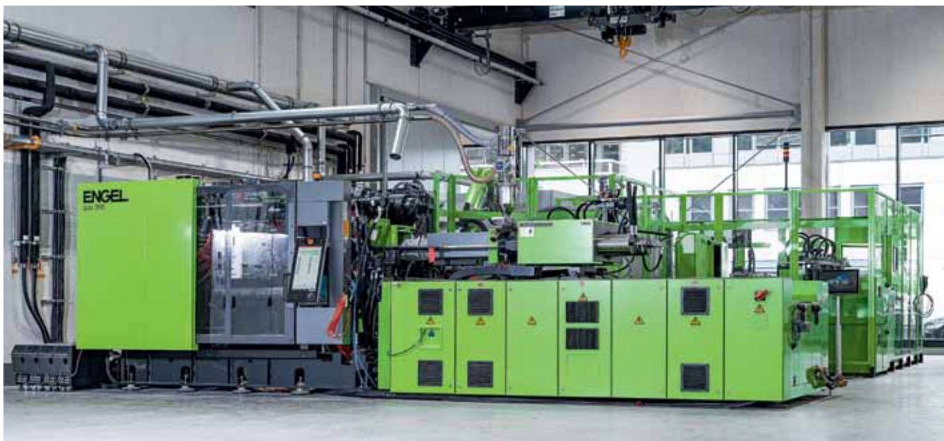
Utilajul de turnare prin injecție de la LIT-Factory din Linz produce capacul de plastic pentru cutia de viteze. Imagine stânga: Rudolf Pichler (smartfactory@tugraz), Claudia Schickling (fabrica pilot Industria 4.0 din Viena) și Georg Steinbichler (LIT-Factory) lucrează împreună (de la stânga la dreapta).
