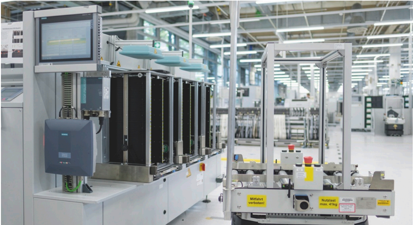
Im Siemens-Werk Karlsruhe ersetzen autonome Transportfahrzeuge die starre Verkettung durch Fördertechnik.
