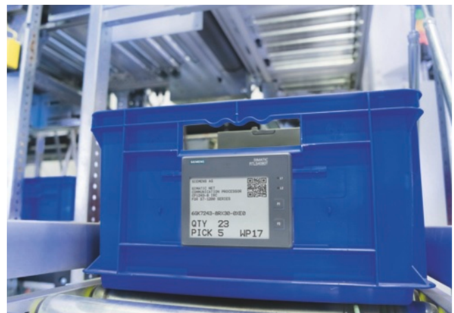
Die ePaper-Display-Transponder von SIMATIC RTLS ermöglichen neuartige Interaktionen zwischen Mensch und Maschine.
