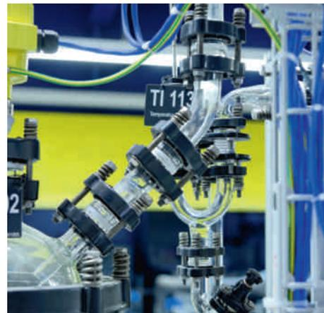
Insgesamt 25 analoge und 19 digitale Messungen zeigen die Prozesszustände (Temperaturen, Durchflüsse, Drücke) in den einzelnen Abschnitten der Rektifikationskolonne an.
