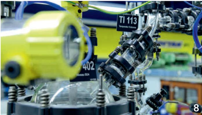
**8:** Für eine neue Rektifikationsanlage an der Hochschule Luzern – Technik & Architektur setzte die Firma Prola AG das Prozessleitsystem PCS 7 in der Microbox-Version ein. Aus didaktischen Gründen ist die ganze Anlage in Glas ausgeführt.
