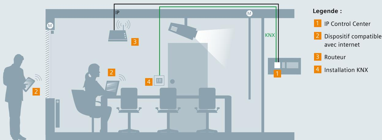
Le N152 IP Control Center est parfaitement adapté aux bâtiments résidentiels ou commerciaux de petites et de moyennes dimensions. Grâce à lui, l'ensemble de l'installation KNX peut être géré et visualisé par le biais d'ordinateurs, tablettes ou smartphones compatibles avec internet, notamment sans fil par WLAN si requis. En cas de défaut, vous êtes informé d'une alarme par email. Tous les équipements KNX peuvent être contrôlés et entretenus ou mis en service à distance.
