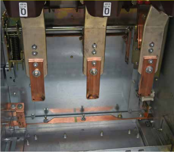
Bild 4 Zustand eines NXAIR-Kabelanschlussraums 12 kV nach einer Störlichtbogenprüfung mit einem Fehlerstrom von 80 kA (Spitze) / 31,5 kA (effektiv), mit Lichtbogenzündung innerhalb des Kabelanschlussraums
