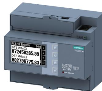
O PAC2200 é um multimedidor capaz de medir as principais grandezas elétricas da instalação e distribuição de energia em baixa tensão. O PAC2200 é montado no trilho DIN e é capaz de efetuar medições monofásicas, bifásicas ou trifásicas e pode ser utilizado em redes TN e TT. Todas as variáveis medidas são apresentadas no display.
