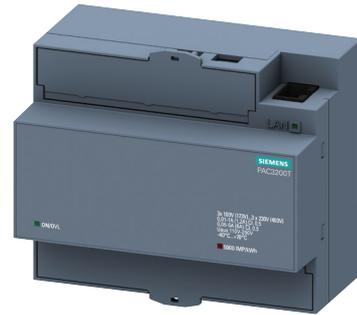
ligado diretamente a qualquer sistema de baixa tensão até uma tensão nominal de UL-L 480V. Os transformadores de corrente de 1A ou 5A podem ser usados para medir a corrente. O protocolo de comunicação Modbus TCP integrado pode ser utilizado para a comunicação.
