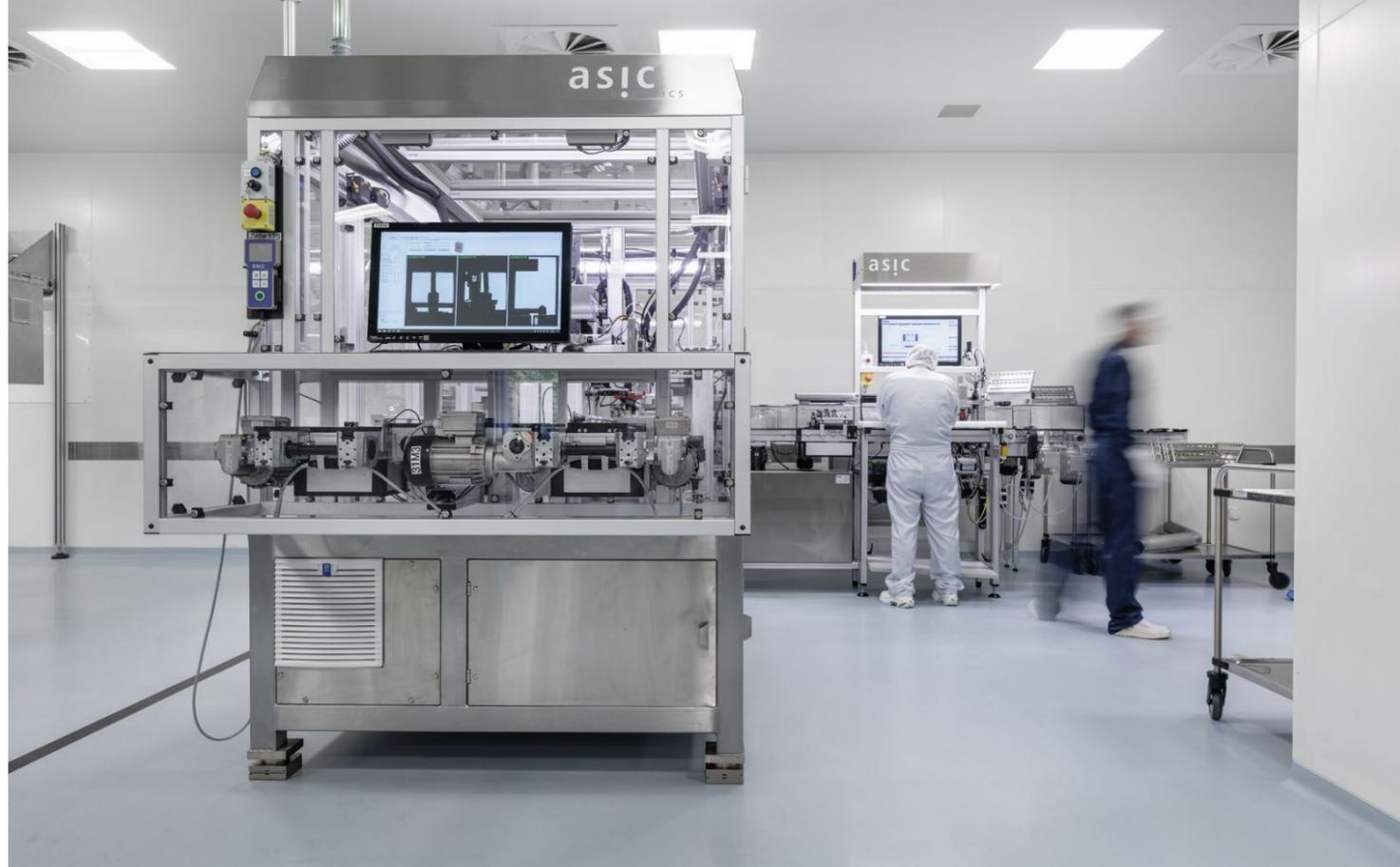
die später mit dem menschlichen Körper in Berührung kommen, werden speziell oberflächenbehandelt und müssen absolut steril bleiben, deshalb erfolgt die Montage in einem Reinraum. Zwei Kameras in der Anlage überwachen die Qualität jedes Arbeitsschrittes.
