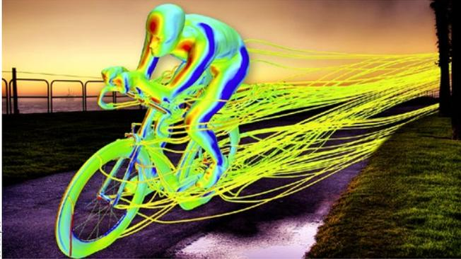
Analyse der Aerodynamik eines Fahrrads von Cervélo
