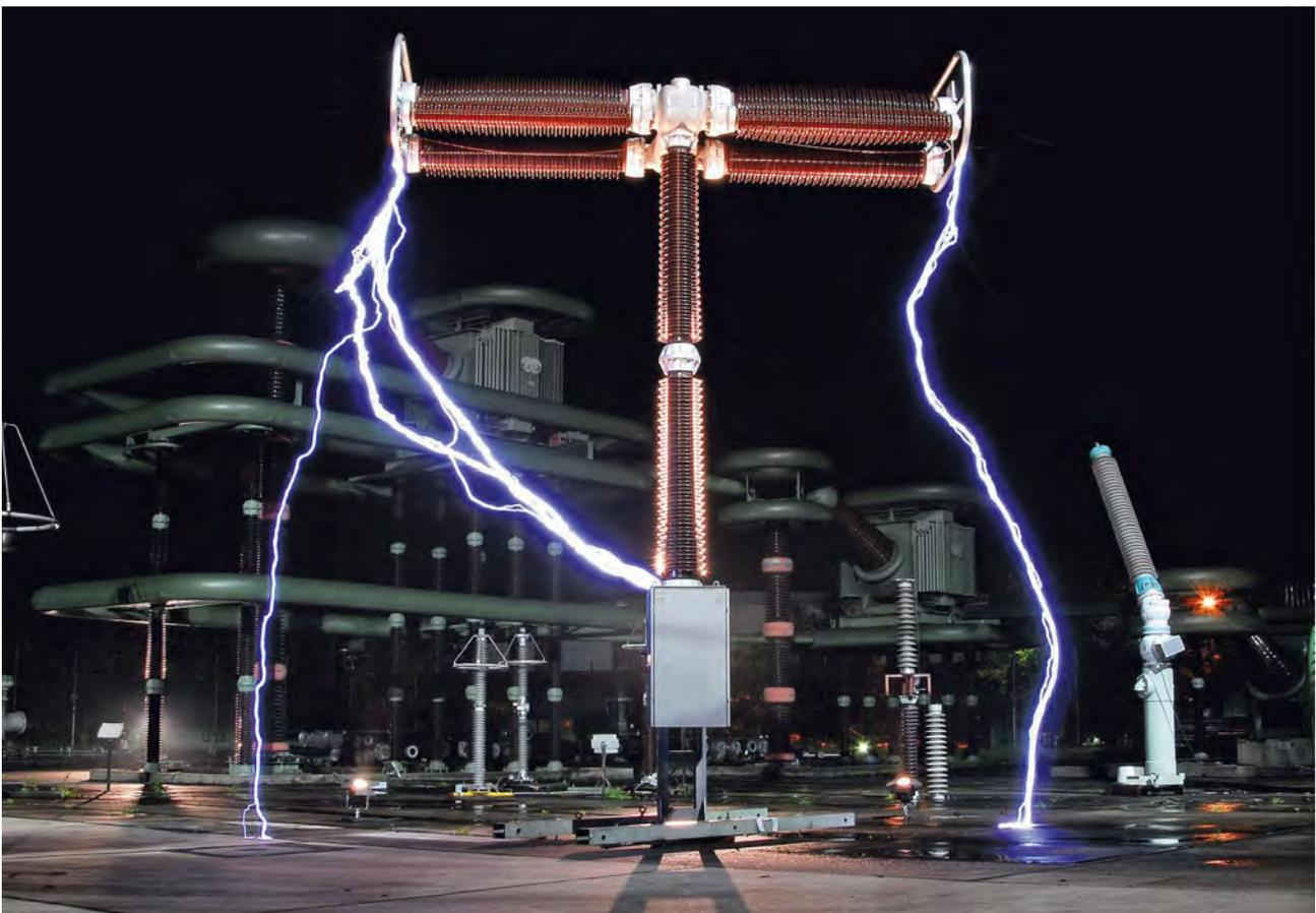
Abb. 1/3: Lichtbogen bei einem Überspannungstest im Siemens Schaltanlagenwerk Berlin
