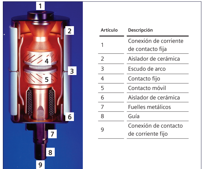
Figura 31: Vista en corte del interruptor automático al vacío
