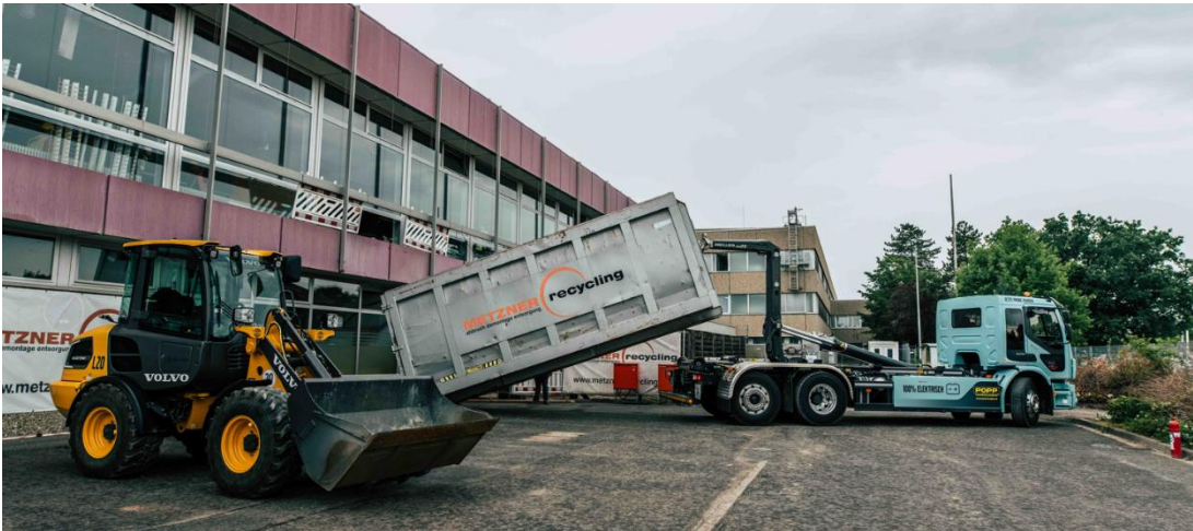
Bild 4: Der Volvo-Radlader L20 Electric übernimmt gemeinsam mit dem Volvo Truck FE 6x2 Electric mit Abrollkipper die Baustellenlogistik.
