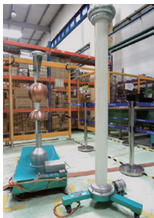
雷电冲击测试系统 Lightning Impulse test system
