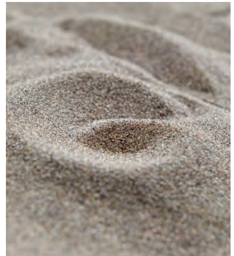
Die Partikel, die dem Wasser beigemischt werden, sehen aus wie Sand. Sie bestehen aus Granat-Mineralien (Silikaten), wie sie beim Sandstrahlen verwendet werden, oder aus Korund (ein Aluminiumoxid). Auch Keramik-Kügelchen (Zirblast) werden eingesetzt.
