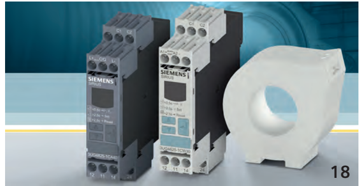
18: Eine neue Lösung zur Fehlerstromüberwachung im Bereich von 30 mA bis 40 A bieten die beiden Relais Sirius 3UG4625 und Sirius 3UG4825 für IO-Link. Sie erkennen Fehlerströme, die etwa durch mangelhafte Isolation an Klemmen oder Leitungen infolge von Feuchtigkeit, Verschmutzung oder Materialalterung in Industrieanlagen und Maschinen auftreten können.
