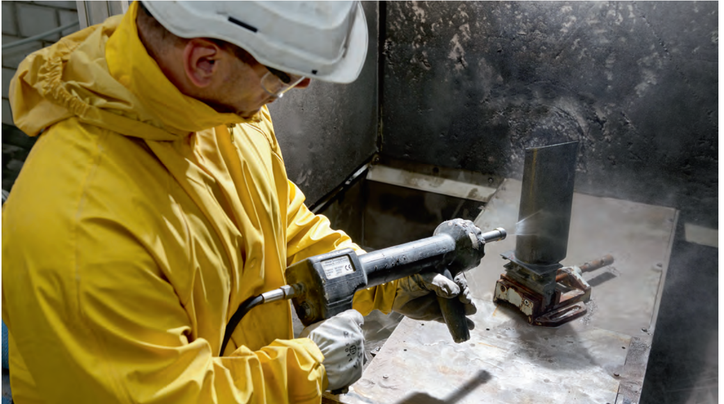
Der feine Wasserstrahl mit den Partikeln aus Korund ist sanft, hinterlässt aber eine deutliche, helle Spur, wo er die Zunderschicht entfernt.
