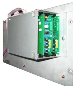
**CEG20** : interface de communication transmettant l'ensemble des télégrammes d'alarme émis par les ECS FC20 (hors FC2020-FZ, FC2020R ni FC2020-1F) vers un réseau Cerloop.
