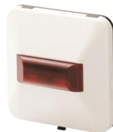
**FDAI92** : indicateur d'action (montage en saillie) qui permet de repérer rapidement un détecteur caché ou peu accessible en alarme ; des diodes électroluminescentes s'éclairent dès que le détecteur concerné est en état d'alarme
