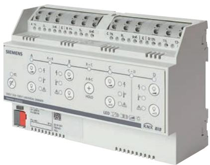
Univerzální stmívač nové generace N 554 rozšiřuje portfolio Siemens GAMMA KNX přístrojů pro ovládání osvětlení. Stmívač umožňuje ovládání intenzity širokého spektra světelných zdrojů typu LED a RLC, navíc s automatickou detekcí připojené zátěže. Čtyři kanály mohou pracovat nezávisle, každý s max. zátěží 300 VA, nebo mohou být sdružovány do skupin po dvou (až 500 VA), třech (až 750 VA) nebo čtyřech (až 1000 VA) kanálech.
