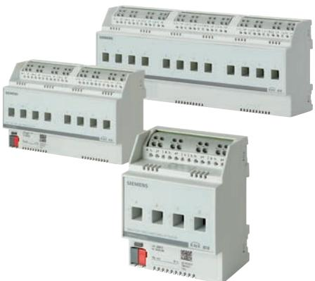
Nová generace spínacích akčních členů N 53.. nabízí celkem 9 přístrojů. Čtyř, osmi i dvanáctikanálová provedení jsou k dispozici se 6A, 10A a 16/20A kontakty pro spínání kapacitních, induktivních a odporových zátěží. Tako široké a modulární portfolio poskytuje obrovskou flexibilitu pro každou aplikaci v automatizaci budov. Přístroje navíc nabízí velmi snadnou instalaci díky bezšroubovým svorkám a nezávislým vstupním svorkám pro každý výstupní kanál.
