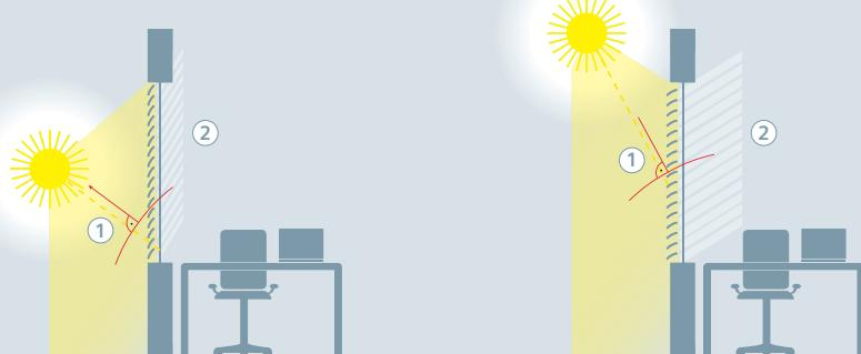
Maximálního využívání rozptýleného denního světla bez oslnění přímými slunečními paprsky je dosaženo vhodným polohováním lamel žaluzí na základě aktuální polohy slunce. Lamely jsou nastaveny tak, aby odrážely maximum přímých slunečních paprsků a nedocházelo k přehřívání interiéru. Zároveň je zachován kontakt s exteriérem, což pozitivně působí na lidskou psychiku.
