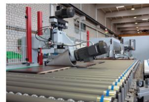
Die Heinrich Kuper GmbH & Co. KG, weltweit agierendes Unternehmen der Holz- und Kunststoffbearbeitung, ist Spezialist für das Retrofit älterer Maschinen. Neue Automatisierungs- und Sicherheitstechnik mit fehlersicherem Software-Controller auf einem wartungsfreien Embedded PC vervielfachte die Performance und Präzision einer Kundenanlage und integrierte die Diagnosefähigkeit. Reduziert wurden die Schaltschrankgröße um 20 Prozent, die Verdrahtung um 50 Prozent und die Maschinen-stillstandzeiten.
