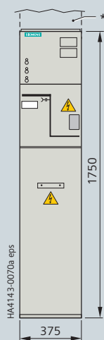
Тип Н, для передачи налево (без трансформатора)
