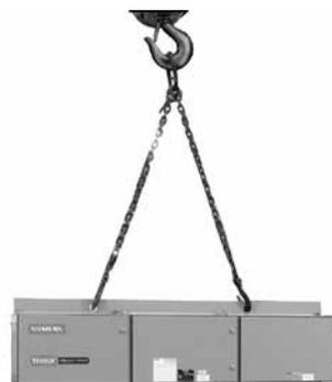
Figura 1. Elevación de un centro de control de motores con un puente grúa
