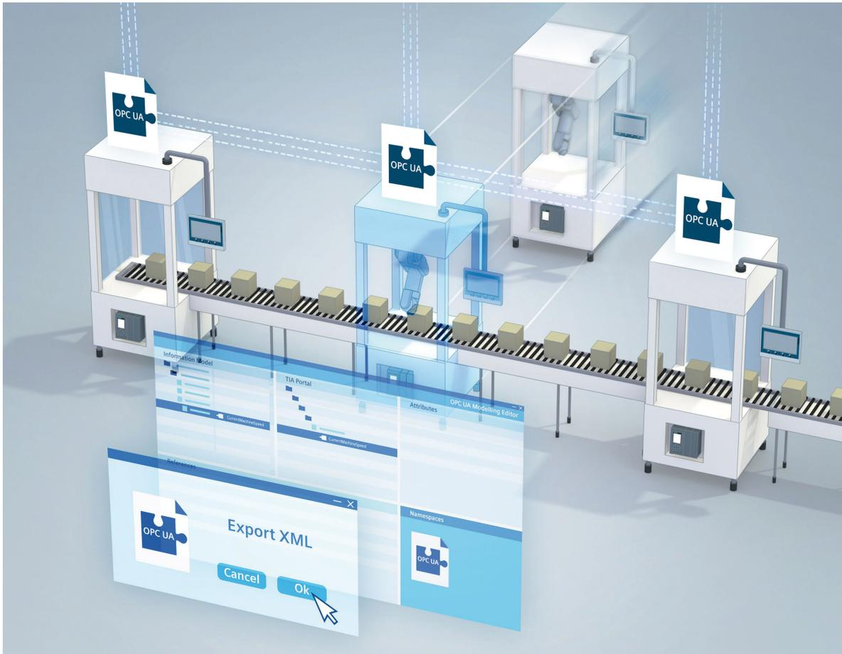
*OPC UA etabliert sich zunehmend als Standard für die Kommunikation zwischen Geräten und Lösungen in der Produktion und überlagerten Systemen*
