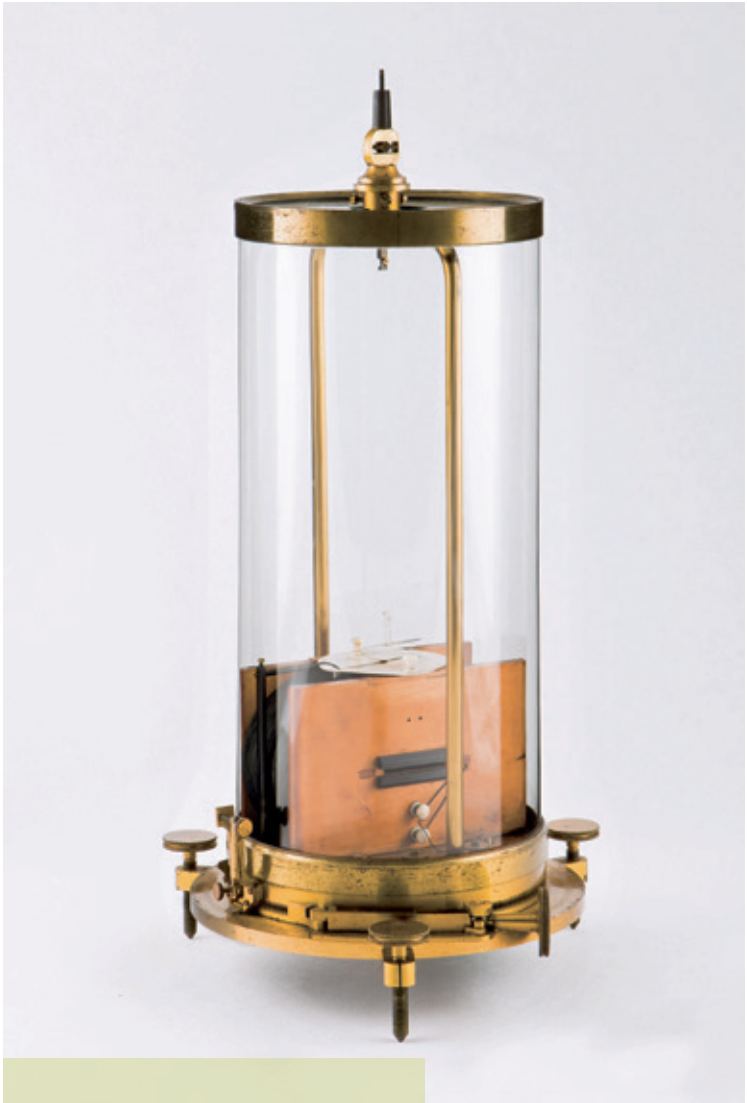
Multiplikator, gefertigt in der Werkstatt von Boetticher & Halske, Ende 1840er Jahre
