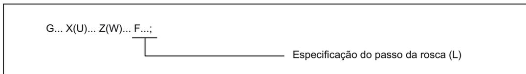
O ciclo para usinagem de roscas cilíndricas, que é apresentado na seguinte figura, é executado nas seqüências 1 até 4 com os comandos indicados acima.
