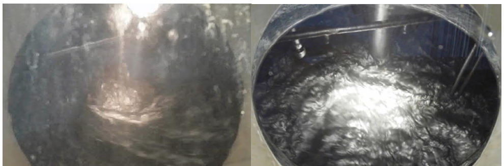
Abbildung 1: Strömungsbild des Kessels vor und nach Modifikationen. Eine links zu sehende Trombe bei relativ glatter Oberfläche ist rechts praktisch vollkommen verschwunden. Die Oberfläche „wallt“ durch die deutlich verbesserte Wirbelbildung des Rührwerks.
