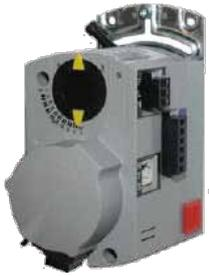
新變風量控制器 ATEC 為控制器與風門驅動器合為一體。其提供壓力無關型 (**pressure independent**) 的 VAV 變風量系統、冷卻及加熱的直接數位控制。ATEC 能獨立或連網工作，以執行複雜的空調控制、監視和能源管理功能。且 ATEC 是 APOGEE 自動化系統的一個組成部份。
