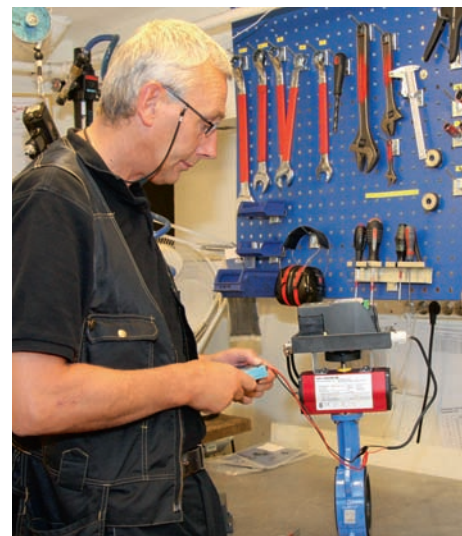
Christer Andersson, instrumenttekniker på Axel Larsson, monterar en ventil i den mekaniska verkstaden. Här görs injusteringar, provtryckning och kundanpassningar av processinstrumenten.
