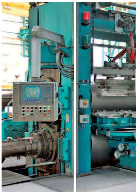
Pupitre opérateur SIMATIC MP 377 installé devant la cage supportant les cylindres. Le métal liquide, amené par les goulottes, passe entre les cylindres.
