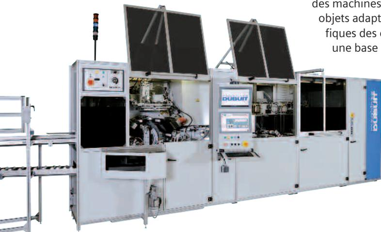
*Sur la machine à jet d'encre, l'IHM permet directement de programmer une mise en fabrication à partir du pupitre et de modifier tous les paramètres nécessaires. Pourquoi une double dalle ? Une des deux dalles est effectivement dédiée au pilotage de la machine. L'autre intervient pour le traitement d'image graphique (992 / machine jet d'encre) ou pour l'affichage des données de vision industrielle (338 / sérigraphie sur wafers).*
