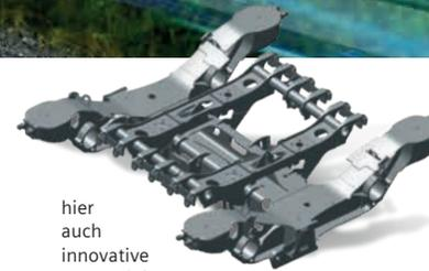
hier auch innovative Konstruktionsprinzipien angewendet, um die Potenziale des für den Drehgestellbau zukunftsweisenden Werksstoffkonzeptes, umfassend wirksam werden zu lassen.
