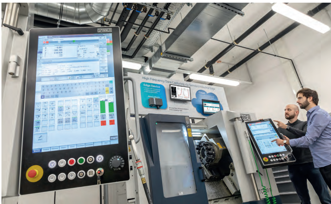
Primer uporabe računalništva na robu v pilotni tovarni smartfactory@tugraz: računalnik zazna okvaro orodja, še preden se ta pokvari.
