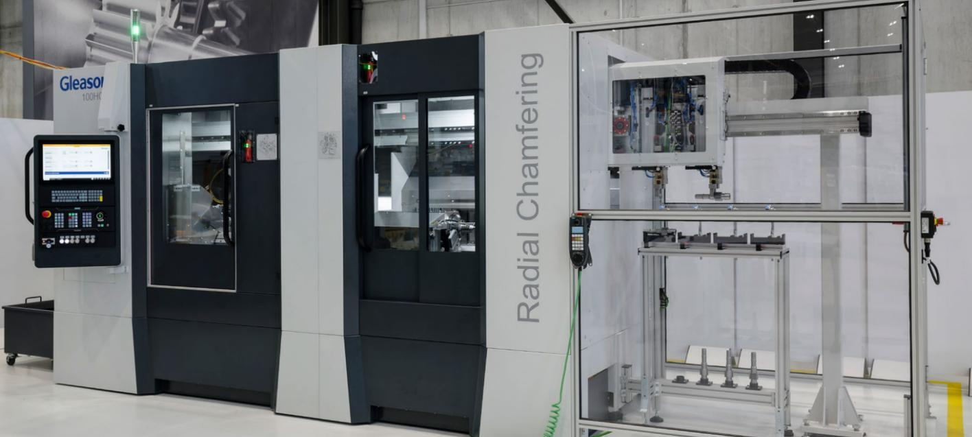
Die neue Gleason 100HCD kombiniert Wälzfräsen und Anfasen in einer Maschine mit SINUMERIK ONE Steuerung.
