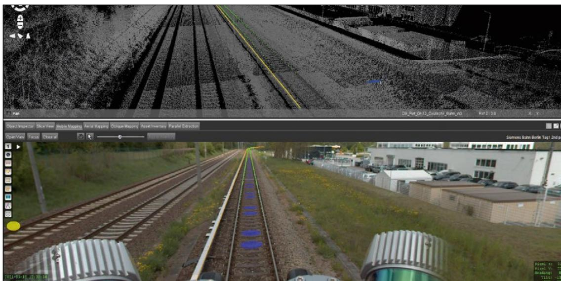
**Bild 1: LiDAR-Scan zur Erzeugung einer georeferenzierten Punktwolke und der dazugehörigen Fotodaten mit anschließender Bereitstellung in einem Web-Viewer**
