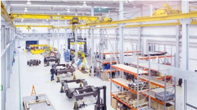
Drehgestelle sind im Bogie Service Center in München-Allach in besten Händen. Unter dem Dach des Rail Service Centers werden Drehgestell-Instandhaltung und -setzung sowie Radsatzrevision und -tausch angeboten. Fachliche Unterstützung kommt aus dem Weltkompetenzzentrum für Fahrwerkstechnik in Graz.
