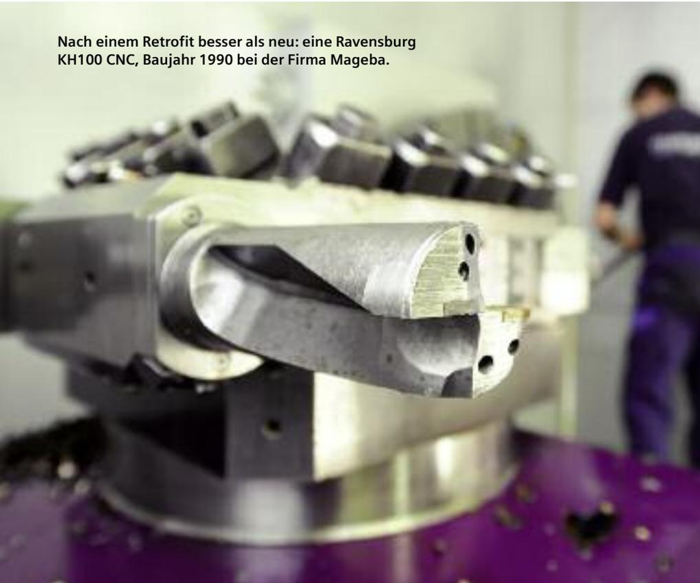
Wenn sich nach vielen Betriebsjahren Störungen und Ausfälle häufen, ist für Werkzeugmaschinen zur Grossteilfertigung ein Ersatz nur zu hohen Kosten und mit langem zeitlichem Vorlauf zu beschaffen. Ein Retrofit der vorhandenen Maschine stellt dagegen die benötigte Produktivität und Produktionssicherheit nicht nur viel günstiger, sondern auch vergleichsweise kurzfristig sicher.
