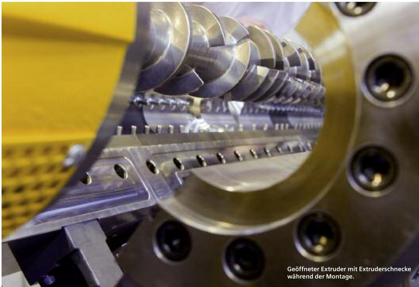
Geöffneter Extruder mit Extruderschnecke während der Montage.
