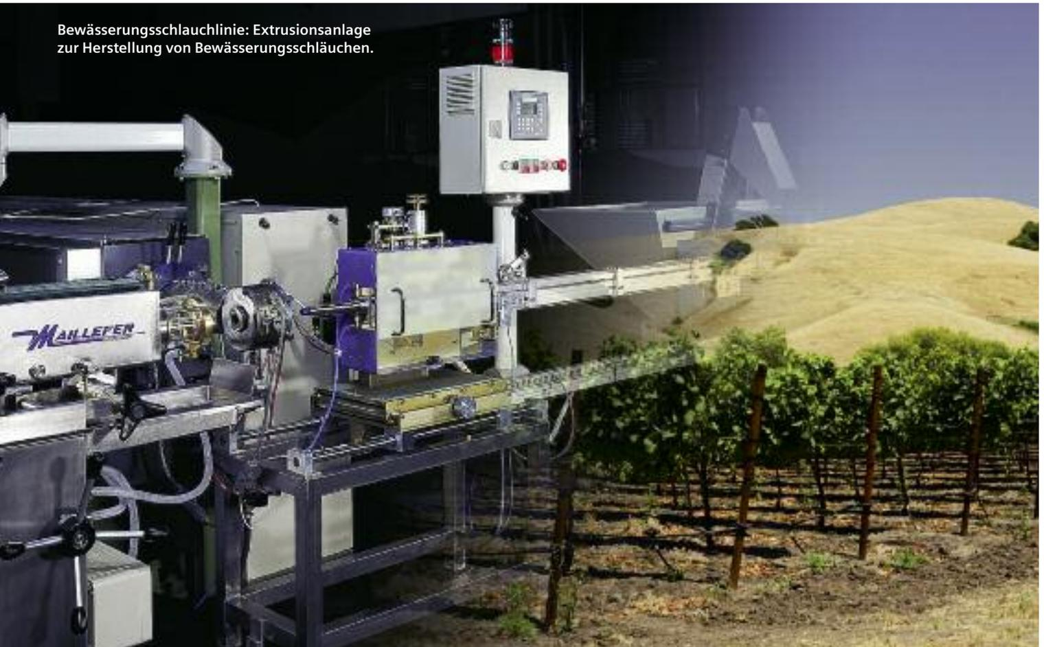
Massangefertigte Extrusionslinien für die Kabelummantelung sowie für die Fertigung von Kunststoffschläuchen und -rohren sind das Kerngeschäft der Firma Maillefer SA in Ecublens. Das Unternehmen stellt bis zu 400 Meter lange Anlagen her, die weltweit zum Einsatz gelangen. Mit Erfolg setzt die Firma für die Steuerung und Überwachung dieser Anlagen auf Sirius Halbleiterschaltgeräte.
