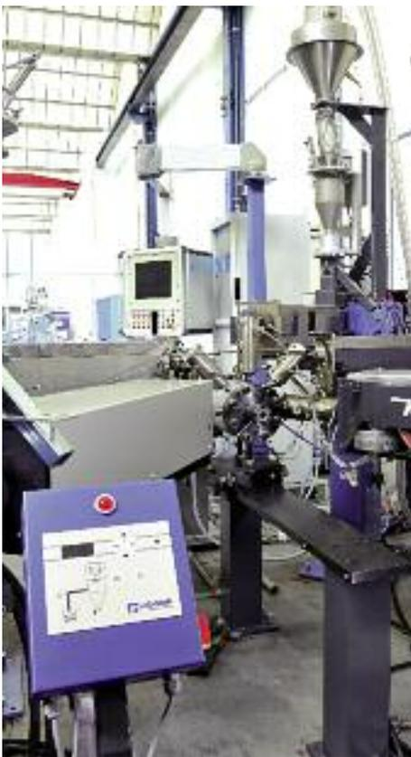
Teilsicht der fünf Extruder mit den Beschickungstrichtern. In der Bildmitte unten das Extrusionswerkzeug mit den verschiedenen Werkstoffzuführungen.
