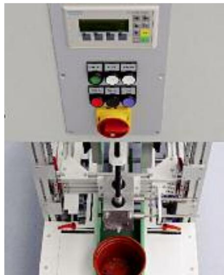
Das Textdisplay mit Bedienfeld, Warnleuchten und Schalter ist übersichtlich und gut erreichbar direkt über dem Zuführband zum Stapelmechanismus angeordnet. Alle Anpassungen an die jeweilige Topfgrösse werden von Hand vorgenommen.
