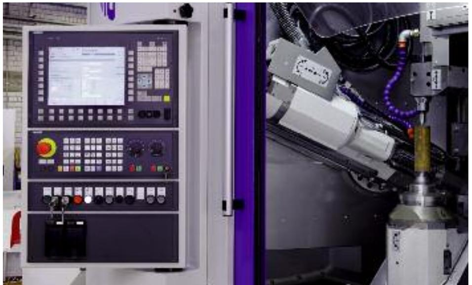
Das digitale NC-System Sinumerik 840D steuert auf der Agilus 180 TH parallel bis zu 11 Achsen und Spindeln.
