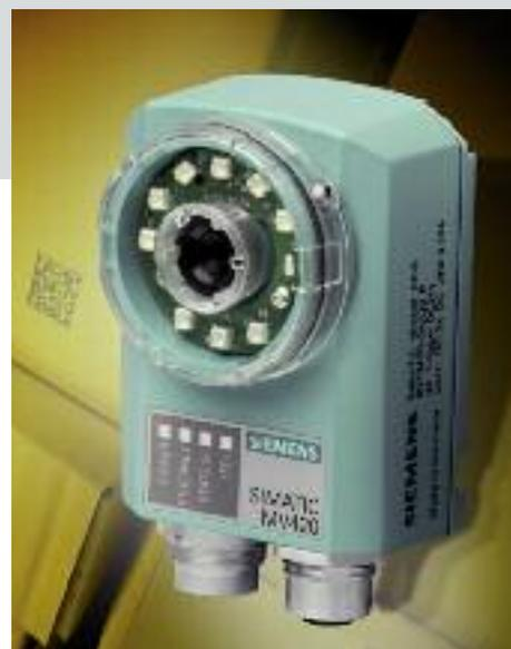
schwierig ist. Simatic MV420 verfügt über integrierte Schnittstellen wie Profinet IO, Industrial Ethernet und RS232. Zum Anschluss an Profibus DP wird ein Kommunikationsmodul eingesetzt, das auch einen Mischbetrieb mit RFID (Radio Frequency Identification)-Systemen ermöglicht. Die Steuerung erfolgt über den gleichen Funktionsbaustein im Step7-Programm.
