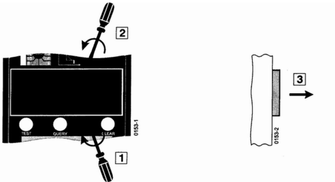
**Установить и надежно закрепить модуль защиты от замыкания на землю**
