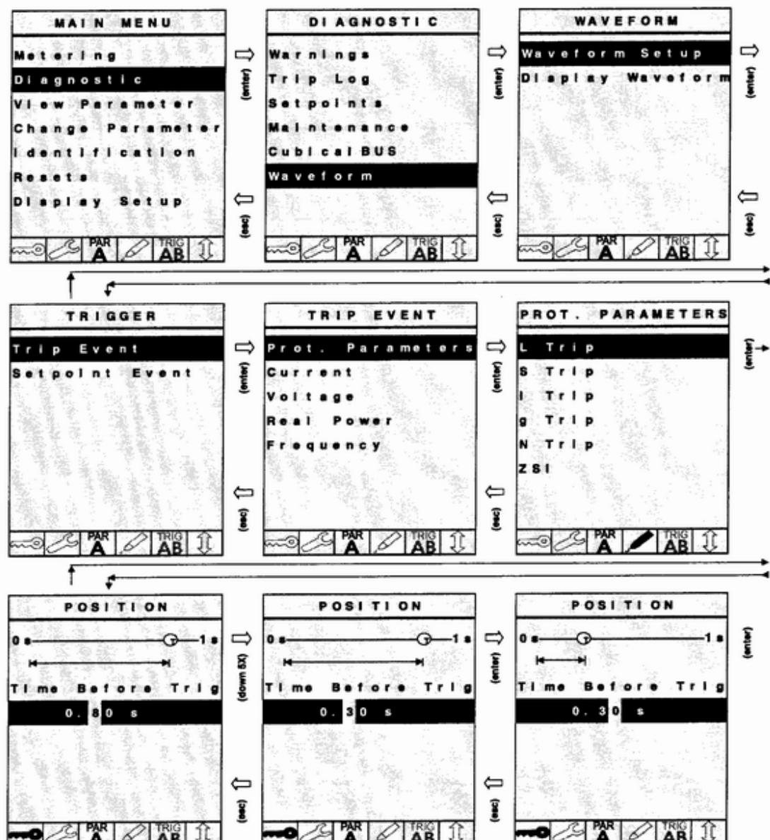
Waveform – Форма волны; Waveform Setup – Задание формы волны; TRIGGER – Запуск (Триггер); Trip Event – Событие срабатывания; Prot. Parameters – Параметры защиты; L Trip – L-срабатывание; POSITION – Состояние (положение); Time Before Trig – Время до запуска; s – секунды
