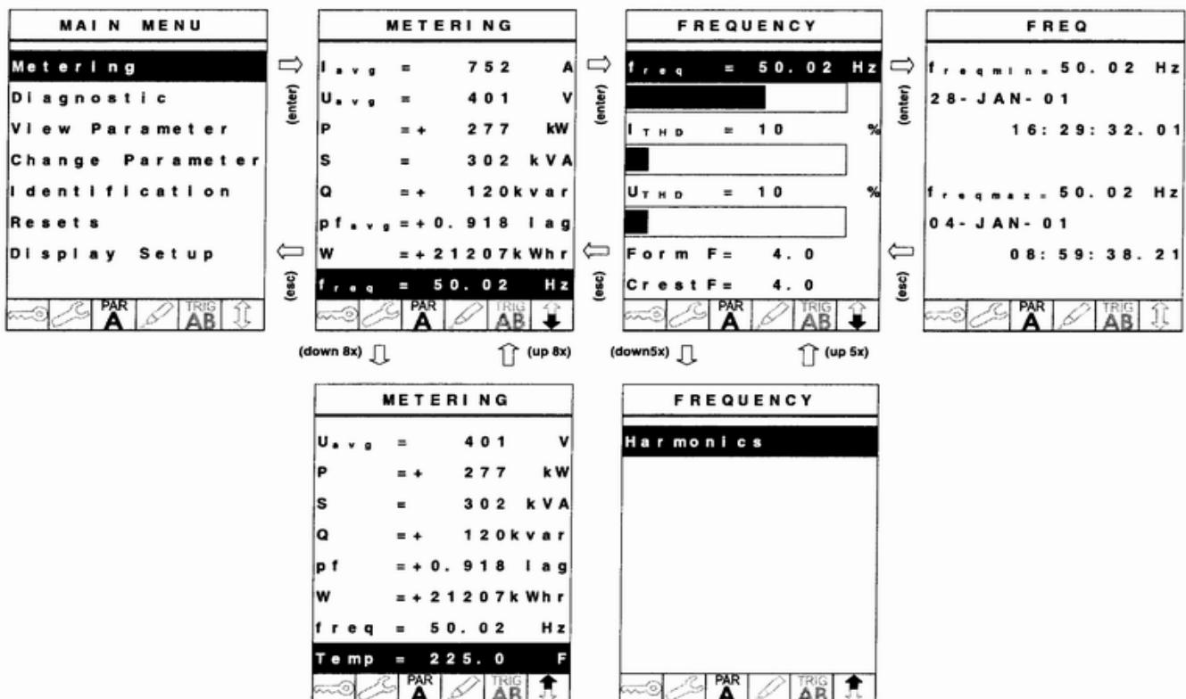
freq - Частота; FREQUENCY, FREQ - Частота; Harmonics – Гармоники
