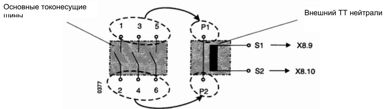
Эта компоновка обеспечивает одинаковое направление электрического тока для автоматического выключателя и внешнего ТТ (измерительного трансформатора тока) нейтрали.
