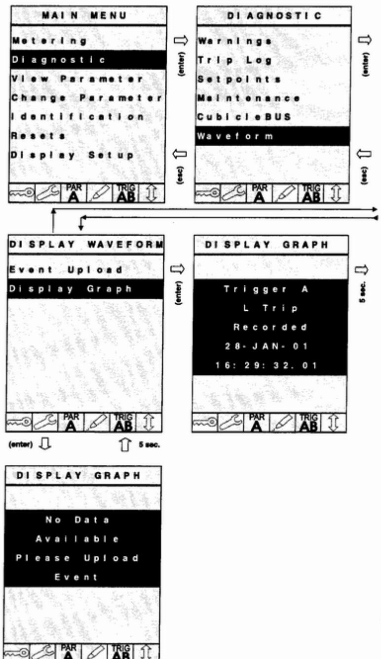
Display Graph – Графическое отображение; Trigger A L Trip Recorded ... - Запуск A, L-срабатывание зарегистрировано ...; No Data Available Please Upload Event – Нет данных. Загрузите, пожалуйста, событие
