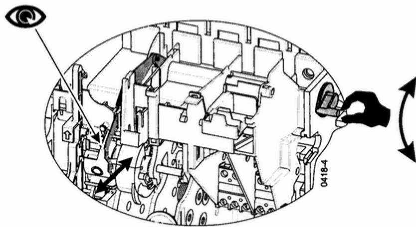
**Установка стопорной шайбы**
