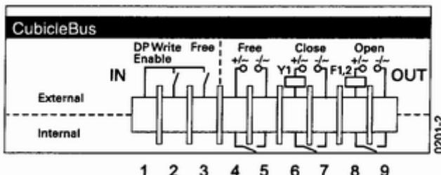
DP Write Enable – Разрешение записи DP; Free - Свободные; Close - Замкнутые; Open - Разомкнутые; IN - Вход; OUT - Выход; External - Внешние; Internal – Внутренние
