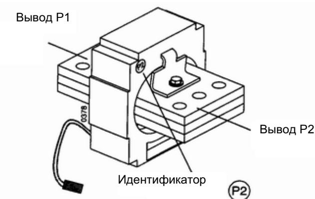
**Вариант для медной шины со стороны распределустройства**
