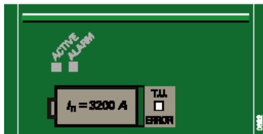
Модуль номинального тока задает номинальный ток в пределах конкретного диапазона данного типоразмера автоматического выключителя.
