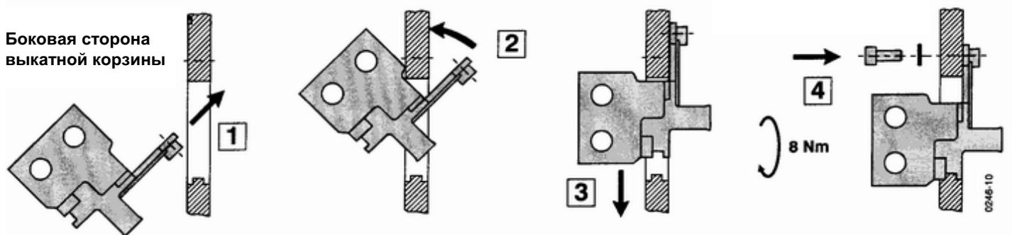
Этапы монтажа для установки горизонтального или фланцевого присоединения такие же.
