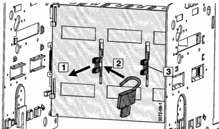
**1** Вытягивайте оба пластинчатых подъемника вперед до тех пор, пока не станет видно продолговатое отверстие
