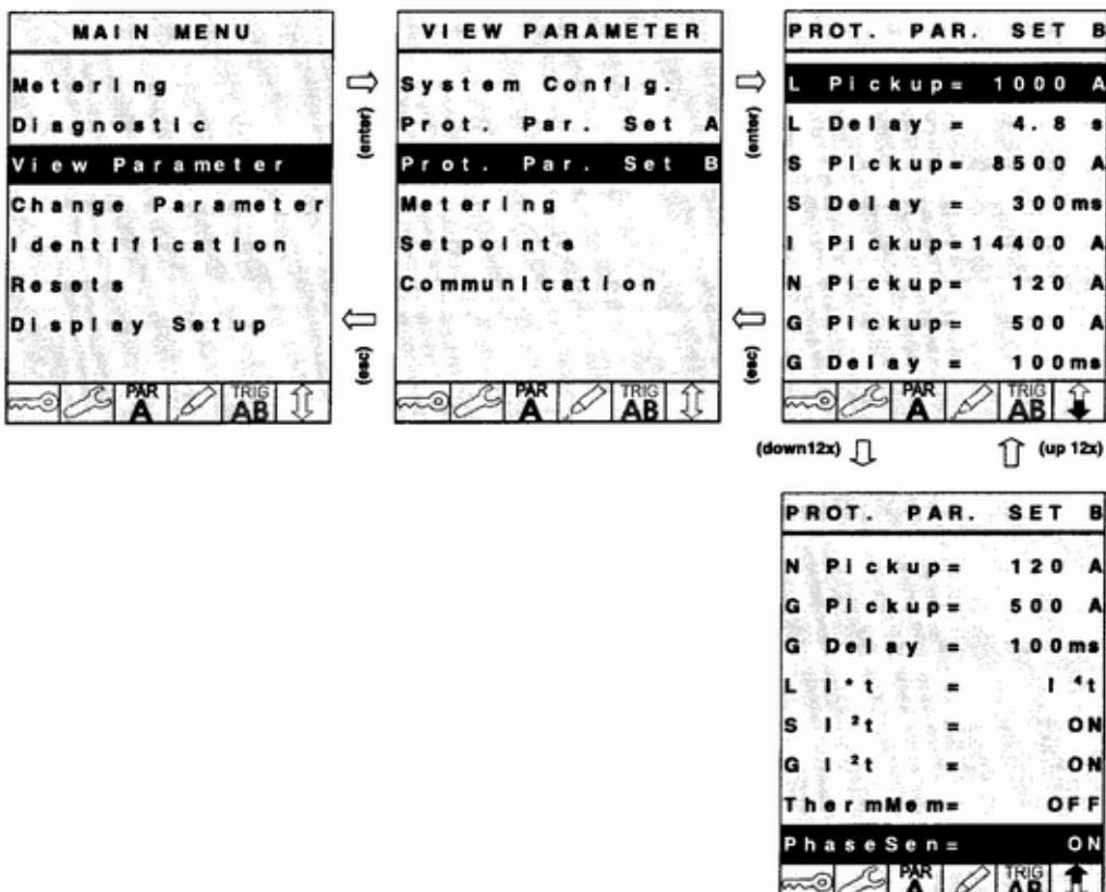
View Parameter – Обзор параметров; Prot. Par. Set – Комплект параметров защиты; L Pickup – L-срабатывание; PhaseSen – Датчик фазы
