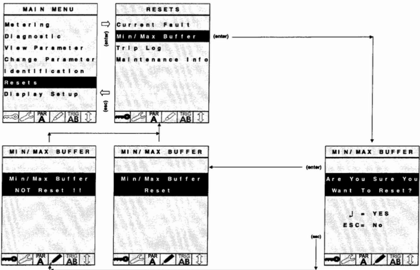
Resets, RESETS - Переустановки; Min / Max Buffer – Буфер минимального/максимального размера; Min / Max Buffer NOT Reset - Буфер минимального/максимального размера НЕ установлен; Min / Max Buffer Reset - Буфер минимального/максимального размера установлен; Are You Sure You Want To Reset ? – Вы уверены, что Вы хотите выполнить переустановку?; YES - Да; No - Нет
