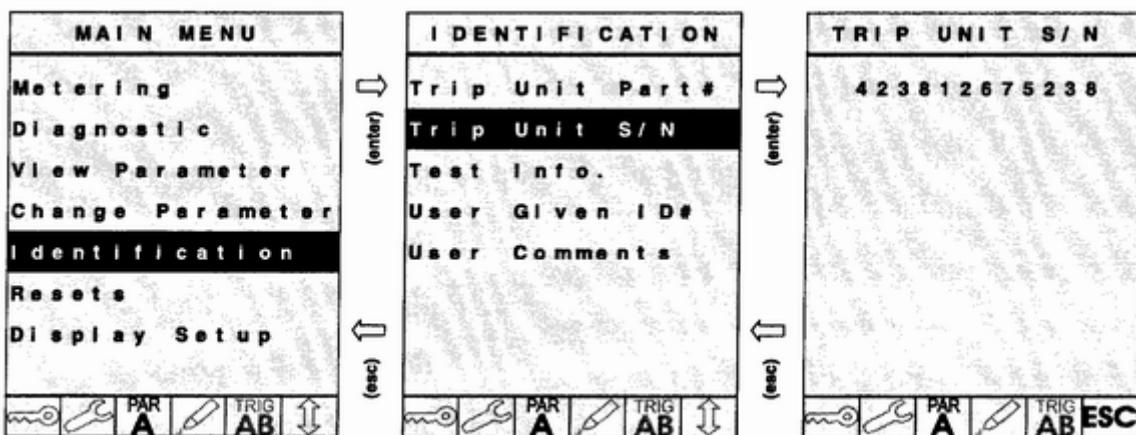
Identification, IDENTIFICATION - Идентификация; Trip Unit S / N - S / N отключение устройств
