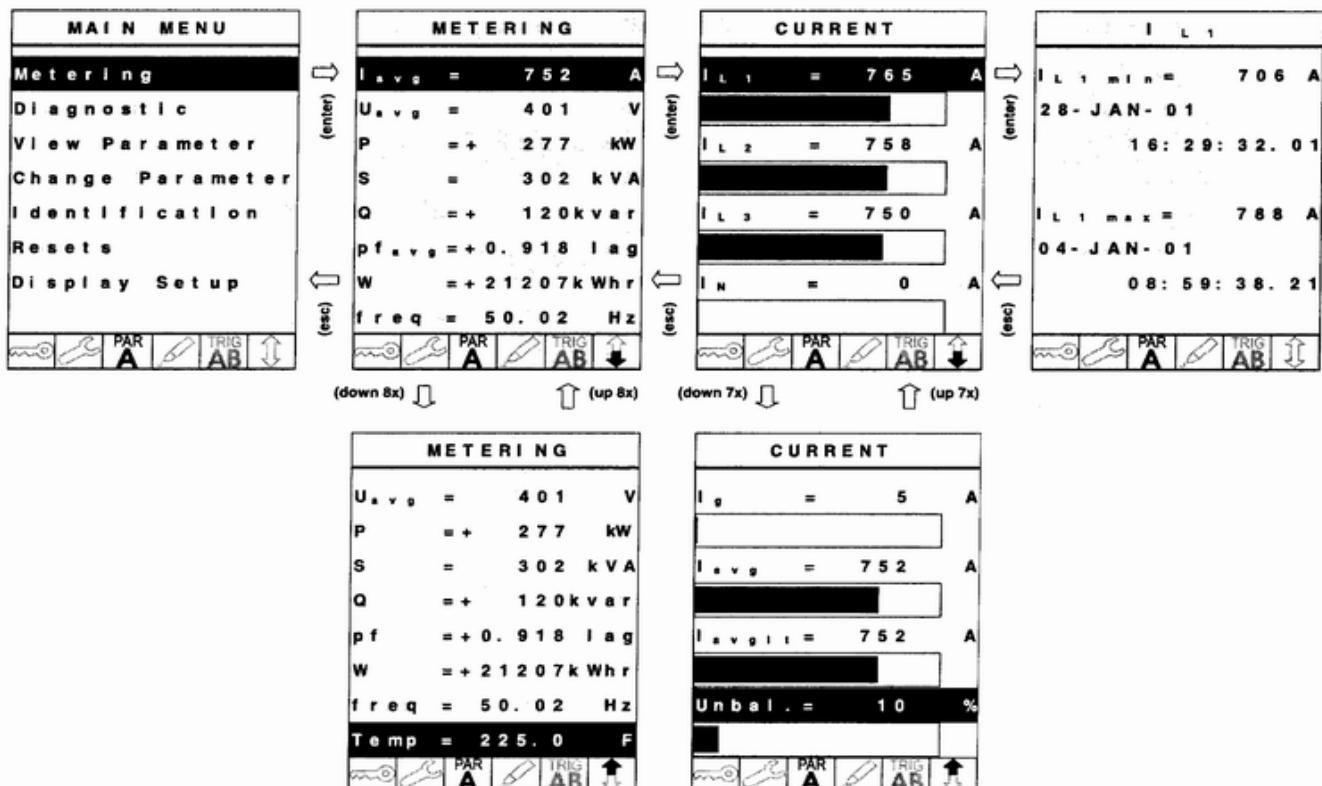
MAIN MENU – Главное меню; Metering - Измерение; METERING - Измерение; Iavg – Средний ток; CURRENT - Ток; Temp - Температура; Unbal. – Несбалансированный
