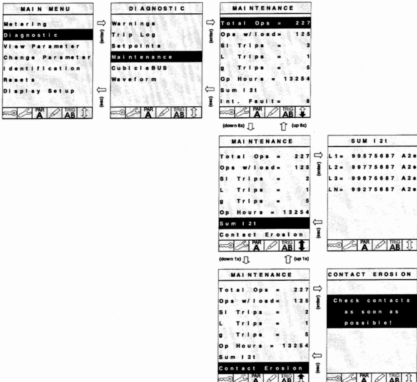
Diagnostic - Диагностика; Maintenance – Техническое обслуживание; Total Ops – Общее количество; Sum - Сумма; Contact Erosion – Износ контактов; Check contacts as soon as possible – Проверьте контакты при первой возможности
