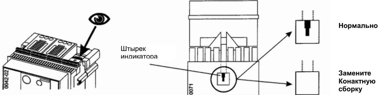
Для визуальной проверки автоматического выключателя стационарного исполнения при необходимости используйте зеркальце.
