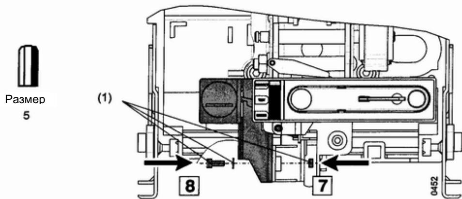
(1) Винт M6 с шестигранным отверстием под торцовый ключ с шайбой и гайкой
