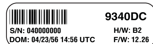
Abbildung 1: Beispiel eines Typenschildes für ein Messgerät ACCESS 9340/9360
