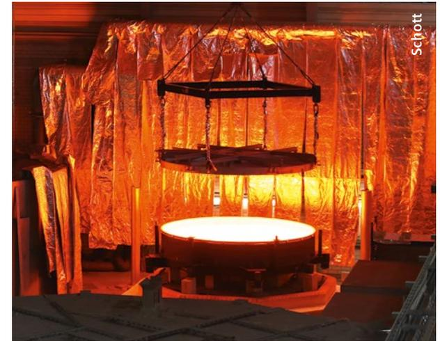
So entsteht einer der Spiegelträger für das größte optische Teleskop der Welt. Im Bild: Öffnen der Gießform in der Kühlhalle bei Schott.
