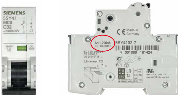
Bild 11a: Bedruckungsbeispiel LS-Schalter, zugelassen nach IEC / EN 60898-1, zusätzliche Aufschrift Icu nach IEC / EN 60947-2
