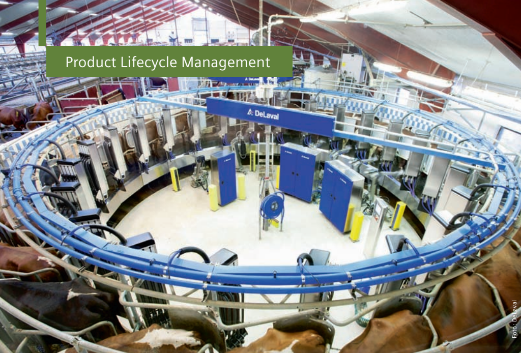
KARUSELL. Mjölkningskarusell konstruerad med hjälp av mjukvaror från Siemens.
