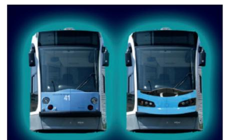
**2:** Tram Frontschürzen im Vergleich. Links die Serienauslieferung, rechts ein Facelift realisiert via Additive Manufacturing
