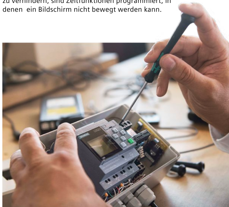
Das Logikmodul steuert neben definierten Bewegungen auch verschiedene Sicherheitsfunktionen der elektrischen Liftsysteme für TV, Monitore oder Beamer
