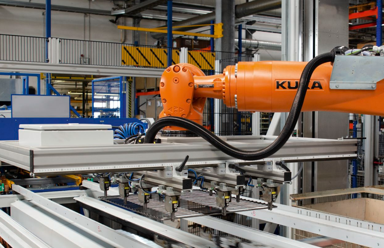
Der Spezialgreifer hebt das Drahtgitter hoch, dreht es um 180 Grad und gibt es an einen zweiten Greifer weiter
