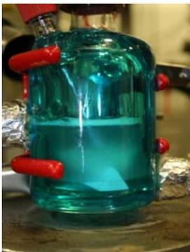
Abbildung 1: LLE-Apparatur mit Doppelmantel zur Temperierung und diversen Anschlüssen zur Entnahme von Proben und Temperaturmessung
