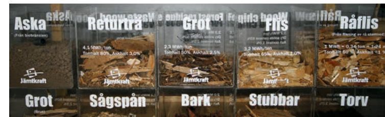
FÖRNYBART BRÄNSLE. I kraftvärmeverket används grenar och toppar som blir över vid skogsavverkning, restprodukter från träindustrin, rötvirke, rivningsvirke och torv; till stor del energi som annars skulle gått till spillo. Värme från rökgaserna återvinns.
