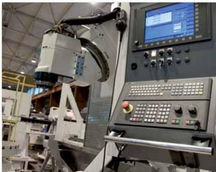
Ce centre d'usinage vertical 5 axes MX 10 est équipé d'une commande numérique SINUMERIK. De quoi usiner de grandes pièces complexes.
