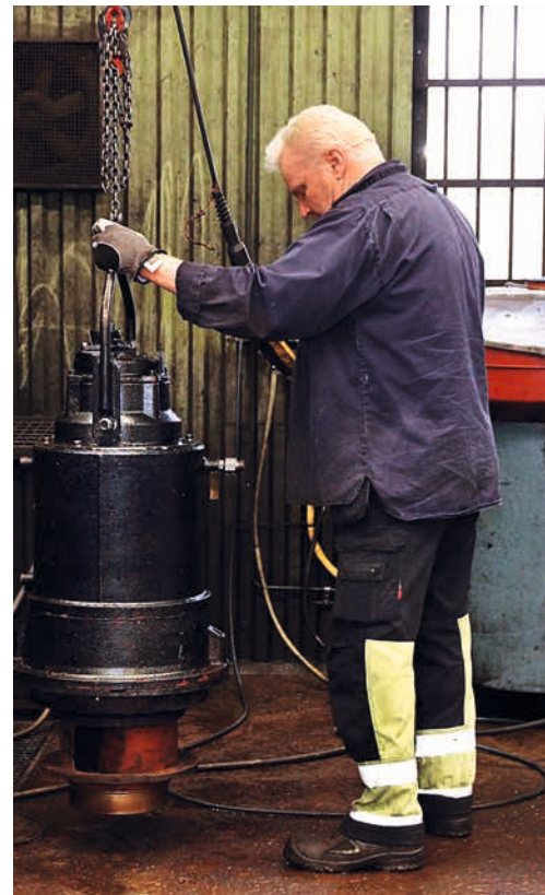
OFFPIST. Krylbo Elektra vibrationsmäter och servar motorerna till snökanoner och liftsystem i Skistars och Stötens skidanläggningar i Sälen. Här är det Roland Bäckström som renoverar en dränkpump.
