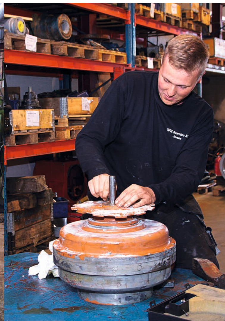
RENOVERING PÅGÅR. WH-Service renoverar motorer, växlar, kopplingar och det mesta kring en roterande utrustning. Här är det en växel som får behandling av verkstadsteknikern Jonas Sundström.
