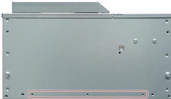
ブラケットを装置に固定します。そのためには付属の M3 ねじを使用してください。最大ねじ込み深さは 5 mm です。
