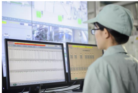
操作员在中控室内通过 WinCC 系统查看生产线生产状况
