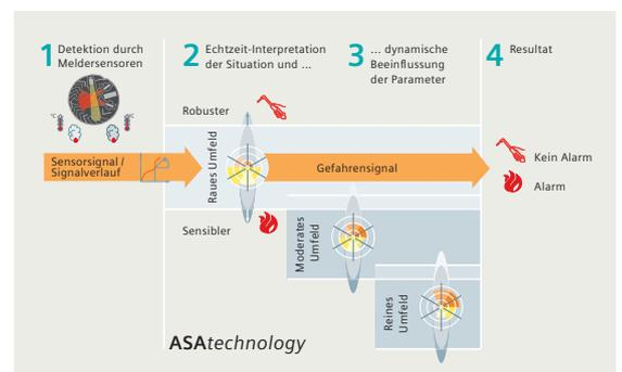
Die dynamische Parameteranpassung der **ASAtchnology** erhöht die Detektions- und Täuschungssicherheit.
