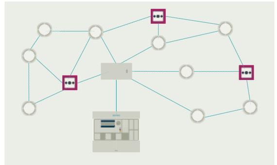
Informationen werden über mehrere Netzwerkknoten (Melder) zum Gateway weitergeleitet – das ermöglicht größere Netzwerke.
