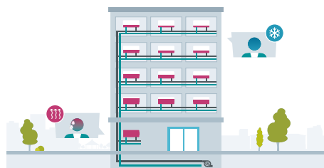
Статическая гидравлическая балансировка: неравномерное распределение энергии в условиях частичной нагрузки.
