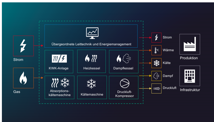
Übersicht Energieversorgungskonzept (Energiezentrale)
