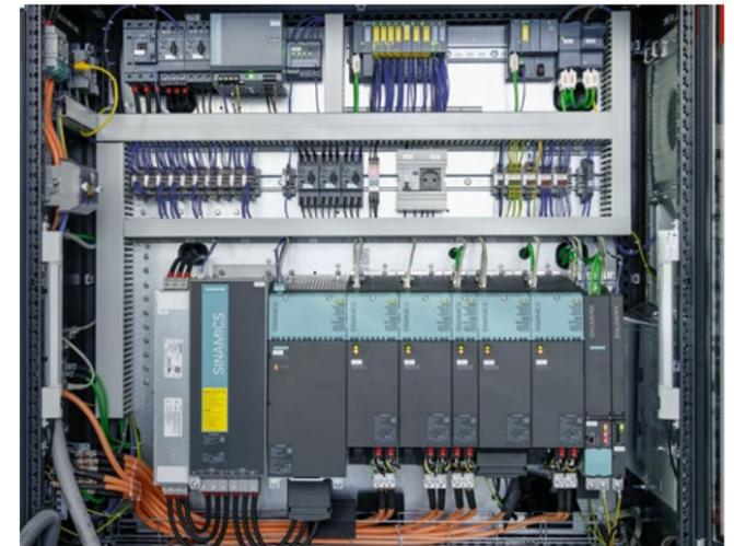
Convertisseur Sinamics, Sitop pour l'alimentation et un système de commande Sinumerik 840D: l'armoire électrique spécifique à une application pour le robot flexible de MABI qui fraise, applique ou positionne avec une grande précision.
